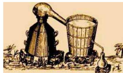
Bulharský typ alembiku mal hríbovitý tvar hlavy a bol nasledovníkom tuniského typu alembiku. Pre svoj tvar a intenzívne chladenie kondenzačnej rúrky bola ružová voda kvalitnejšia
