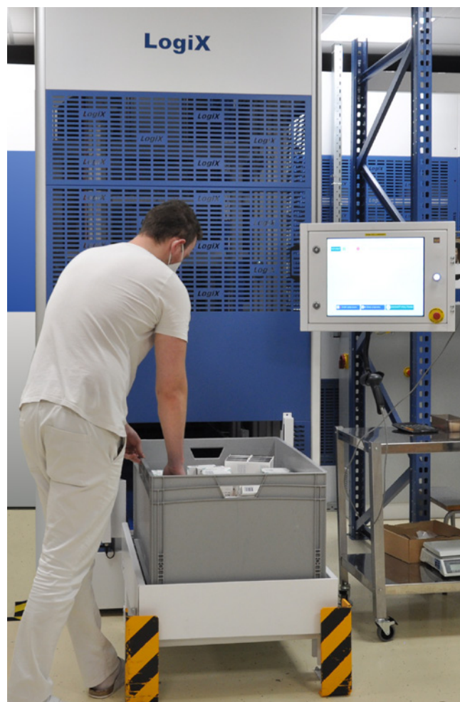
Zakladač EK 7740-LogiX je komplexný, moderný a výkonný systém na automatické naskladňovanie a vyskladňovanie špecializovaného zdravotníckeho materiálu a iného lekárenského sortimentu.
