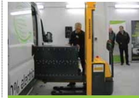
Ukážka výmeny batériového boxu
